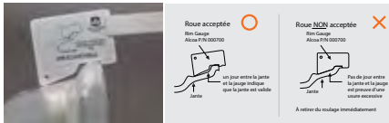
<Bride de jante déformée/usée avec bords tranchants>
