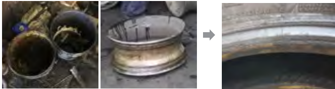
<Application d'une pâte de montage inadaptée>
