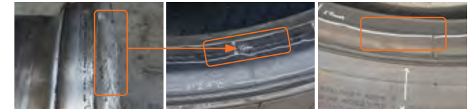
<Jante déformée utilisée>
