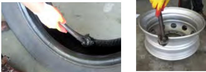
<Application de pâte de montage agréée>
