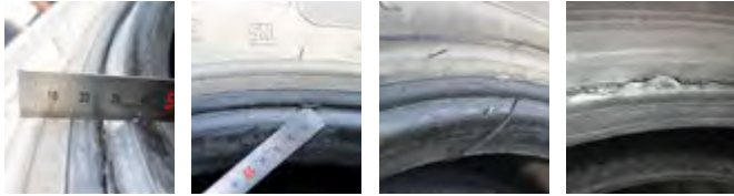
<Talon de pneumatique déformé>
