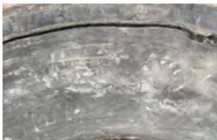
Séparation des nappes ceinture
