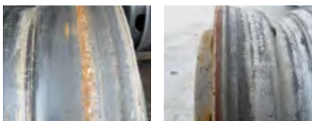
<Roue en acier corrodée>
