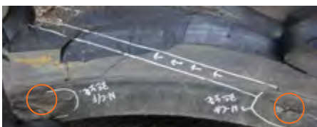
<Dommages lors des procédures de montage>
