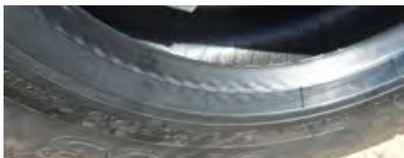
<Déformation du talon due à une pression excessive de la machine automatique>
