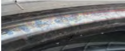
<Nombreuses craquelures sur le talon>
