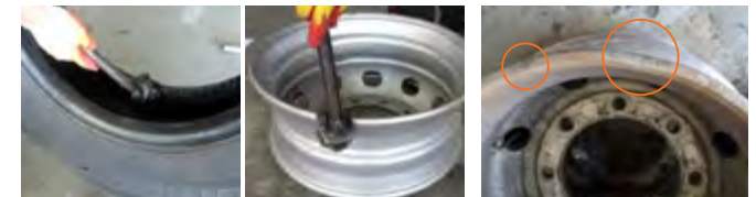
<Pâte de montage correctement appliquée>
